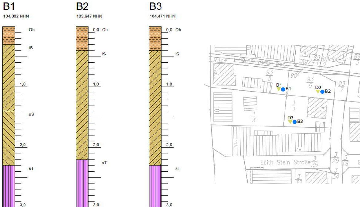
Bohrprofile und Ausschnitt Lageplan der Bodenuntersuchung IPW November 2022
