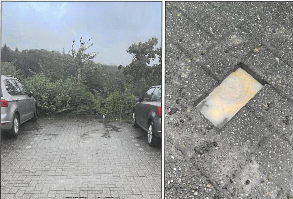
**Abbildung 1:** Blick in Richtung Südwesten/Westen vom 31.07.2023, nördlicher Parkplatz, Versuchspunkte RKS 4 und OET 3, nach Aushebeln des Pflastersteins bei OET 3: Stauwasser annähernd bis in Höhe der Geländeoberkante
